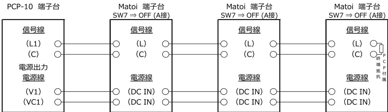
\* 各回線の最終端末センサーに終端抵抗 (PCP-10付属) を接続
