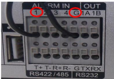
例) 1CHにアラーム信号を行う場合 『ALARM IN』の1とGにケーブルを接続します。
