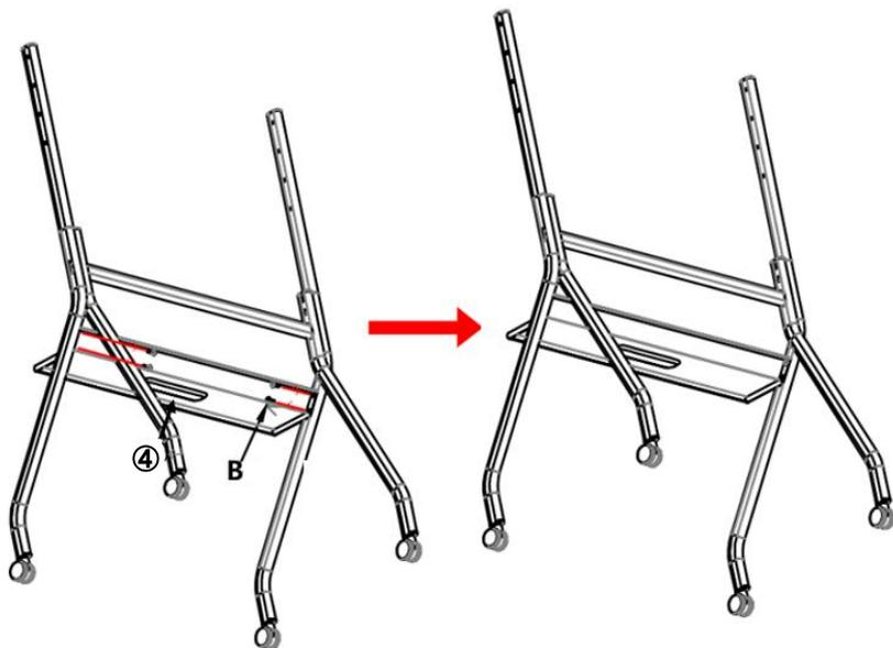
6. 下の図のように、ネジAとナットDを使用して⑤を前項で作ったものを接続します。高さは調節可能です。またこの際に向きや対応する穴に注意してください。
