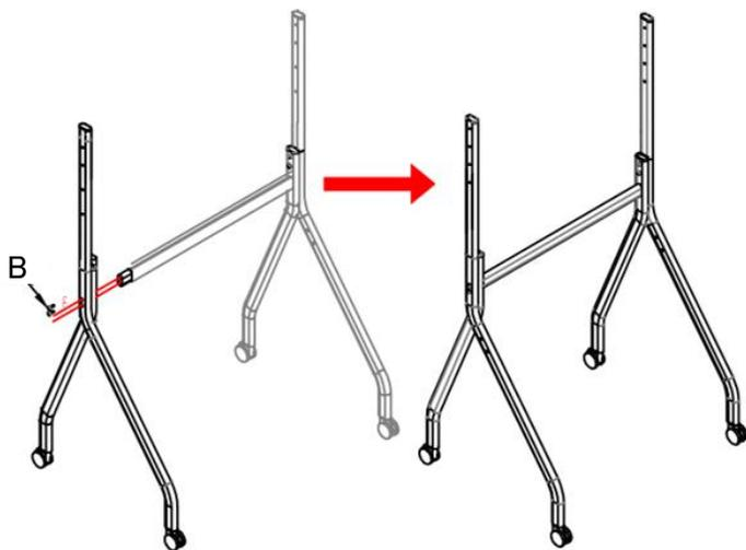
5. 下の図のように④にネジBを使って前項で作ったものに接続します。
