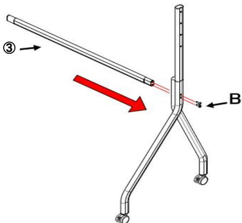
4. 下の図のようにネジBを使用し反対側も接続します。
