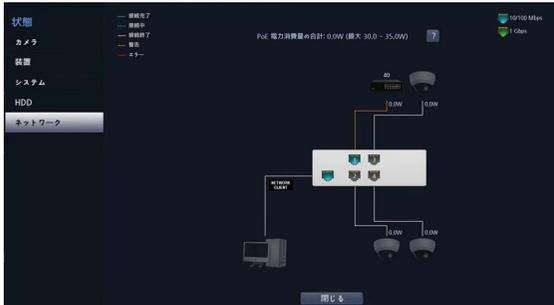
表示される情報は、カメラ接続の有無、LANポートリンクの状態、電力使用量、接続されているクライアントの台数、ネットワーク情報の詳細な説明は次の通りです。
