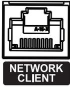
本NVRはイーサネットコネクタを利用してネットワークに接続することができます。NVRコネクタにRJ-45ジャックを使用するCat5e/Cat6ケーブルを接続します。NVRは遠隔地から監視、検索、制御およびソフトウェアのアップデートができます。イーサネット接続設定に関する内容は、[設置運用マニュアルのネットワーク設定](#)を参照ください。
