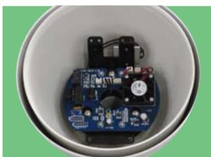
3.ハウジング本体に基盤部分を3つのネジで取付けます。
