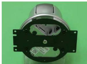
1.ウェブカメラをカメラ取付台(4)に固定します。
