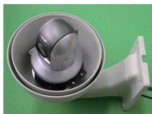
6.カメラ取付台(4)をハウジング本体に固定します。
