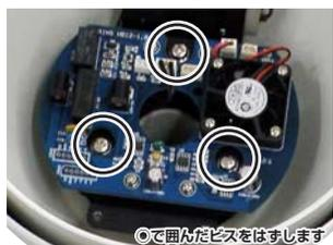
1.ハウジング本体(2)から3つのネジをはずして、基盤部分を取り外します。
