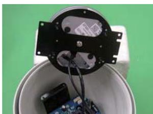
5.電源ケーブル(7)とLANケーブル(9)をカメラに差し込みます。
