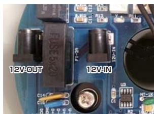
4.電源ケーブル(8)を基盤の[12V-IN]に挿入、電源ケーブル(7)を基盤の[12V-OUT]に挿入します。
