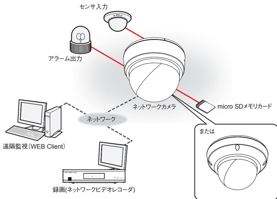
PCにインストールしたソフトウェアによってネットワークに接続されたカメラを制御します。
