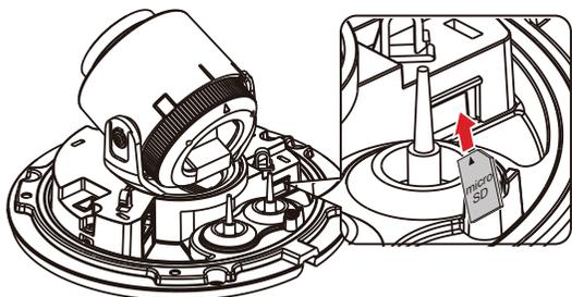
✔ スロットからSDメモ리카ードを取り外す時は、SDメモ리카ードの端部分を少し押してください。
