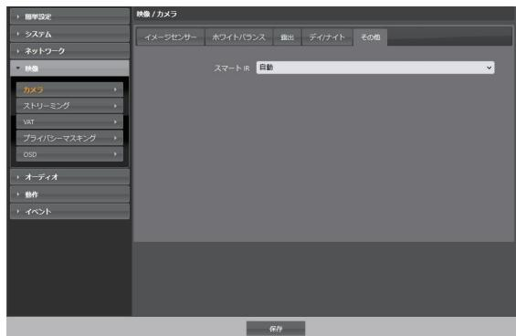
**スマートNIR** : IR LEDの明るさを調節します。値が大きいほど明るくなります。被写体が近づいてきた時に、赤外線の光量を調節して白とびを抑え、より鮮明にします。
