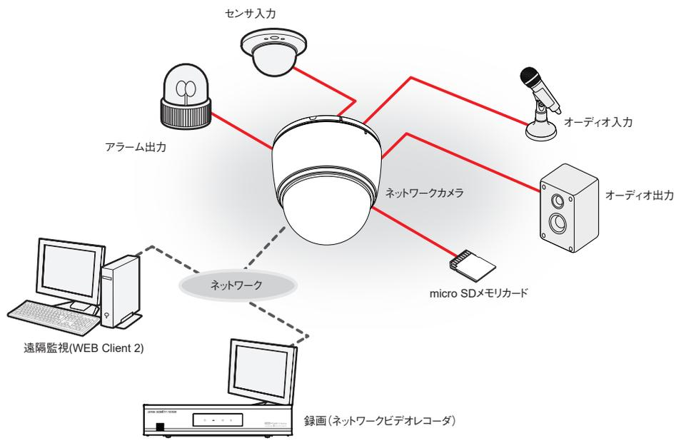
PCにインストールしたソフトウェアによってネットワークに接続されたカメラを制御します。
