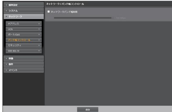
**ネットワークバンド幅制限**を選択すると、最大バンド幅を設定します。この場合、ネットワークトラフィック発生時に設定された帯域幅以上は使用できません。
