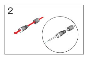
2 ネットワークケーブルにRJ45コネクタ保護カバーと RJ45コネクタ・バックカバーの順番に通します。
