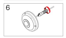
6 RJ45モジュラージャックとRJ45コネクタ保護カバー を接続し、回転して固定します。
