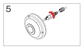
5 RJ45コネクタ保護カバーとRJ45コネクタバック カバーを接続し、回転して固定します。
