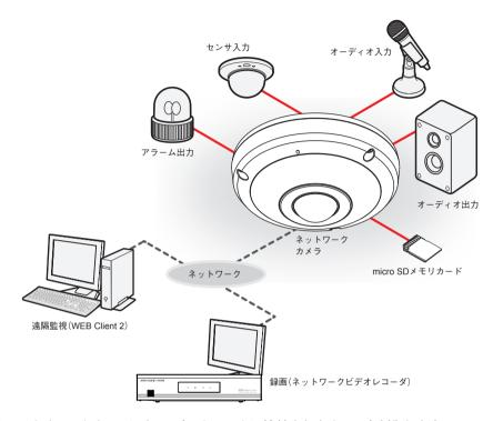
PCにインストールしたソフトウェアによってネットワークに接続されたカメラを制御します。 画像を録画する場合は、ネットワークビデオレコーダが適しています。
