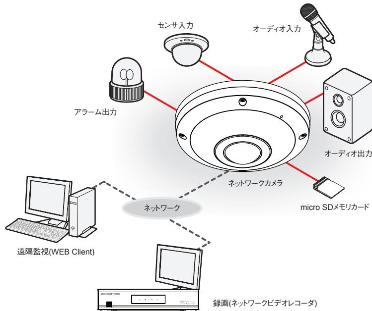
PCにインストールしたソフトウェアによってネットワークに接続されたカメラを制御します。
